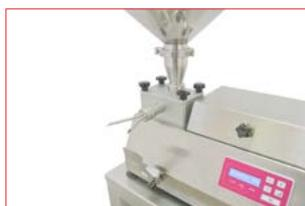
Boquilla inyectora doble
