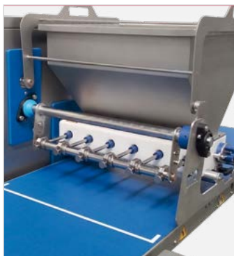
Banda transportadora adaptada para el dosificado en continuo de plancha de bizcocho.
