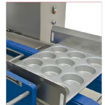
Cinta de arrastre con sistema para colocar bandejas de diferentes medidas.
