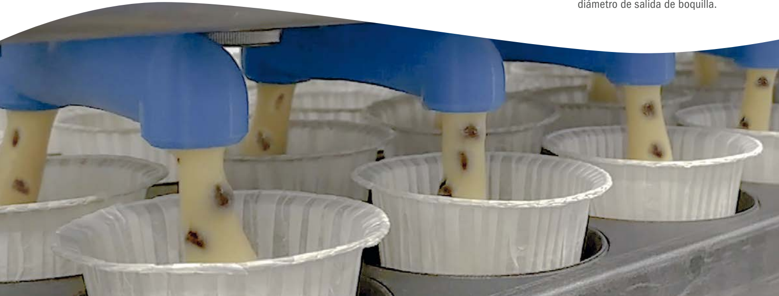
Boquilla orientable en S, lisa o rizada.
