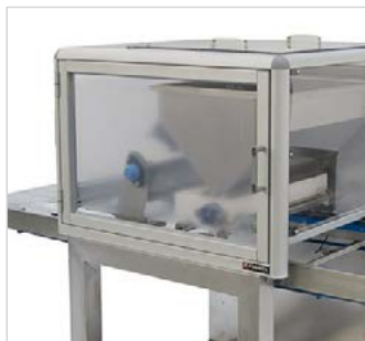
Urna calefactada para mantener el producto en condiciones óptimas de trabajo.
