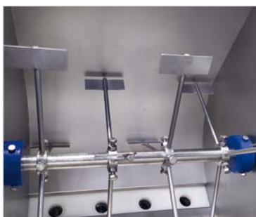
Depósito con agitador de mezcla para masas muy densas con trozos que requieran que el producto esté continuamente en movimiento.
