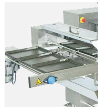
Transportador diseñado para situar tres bandejas planas.
