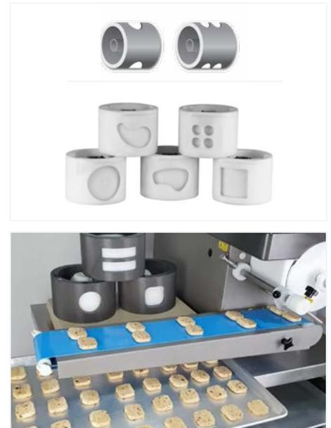
Máquina compacta y funcional para formar productos de pastelería y confitería en una gran variedad de formas. Ideal para elaborar producto de hasta 120 mm de diámetro.
