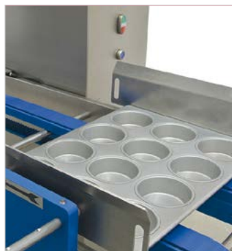
Cinta de arrastre con sistema para colocar bandejas de diferentes medidas.
