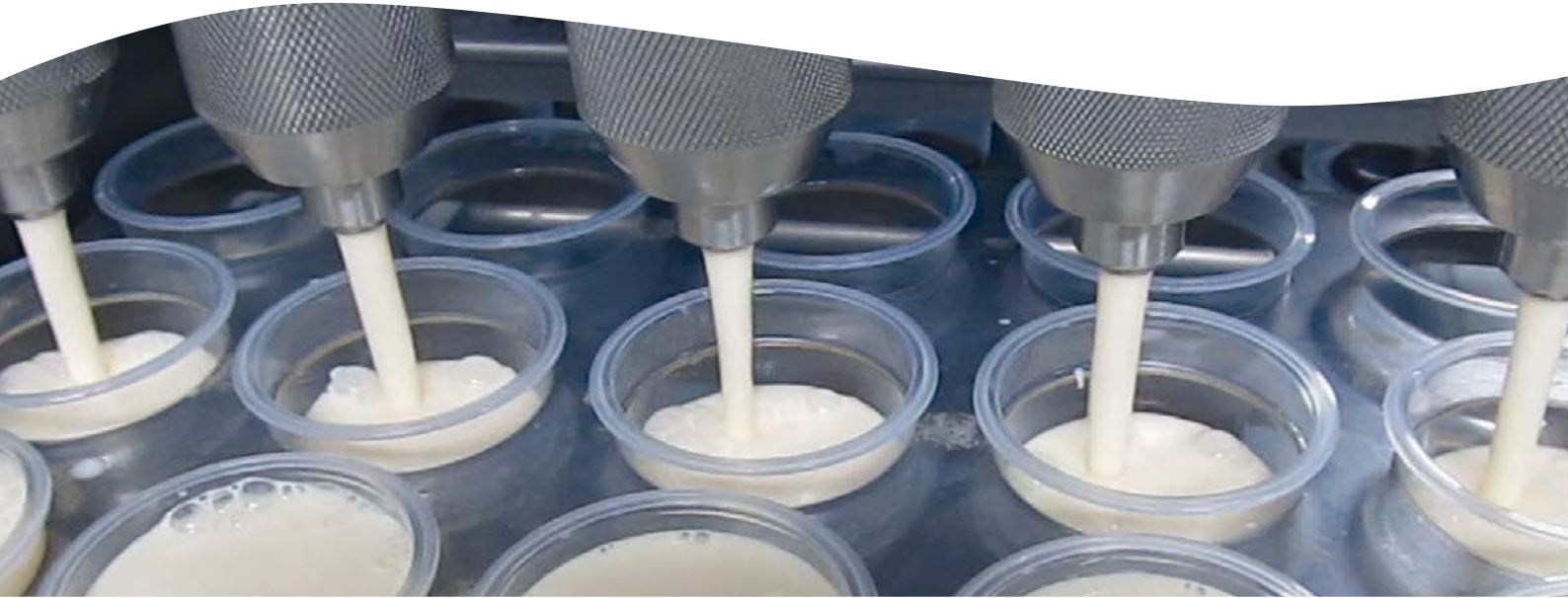
Boquillas con adaptador en forma de ducha para que la dosis quede repartida según la forma del donut.
