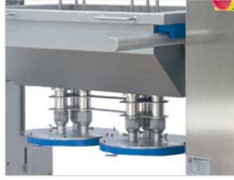
Adaptador en forma de ducha para repartir la salsa de tomate en toda la base de la pizza. Pistón de más calibre.
