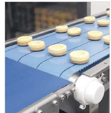
Banda transportadora con serigrafía para colocar el producto adecuadamente.
