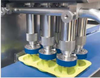
Boquillas con adaptador en forma de ducha para que la dosis quede repartida según la forma del donut.
