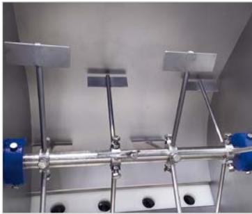
Depósito con agitador de mezcla para masas muy densas que requieran que el producto esté continuamente en movimiento.
