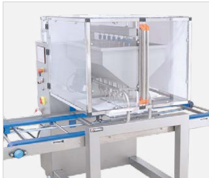
Urna calefactada que mantiene el depósito y las boquillas a temperatura constante.
