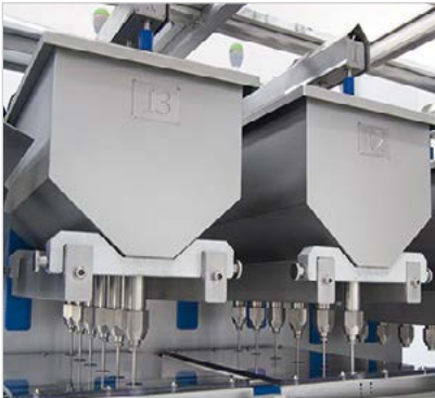
Urna con doble depósito calefactado para el relleno de dos sabores.
