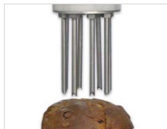
Gran aguja inyectora en círculo para el relleno de panetonne
